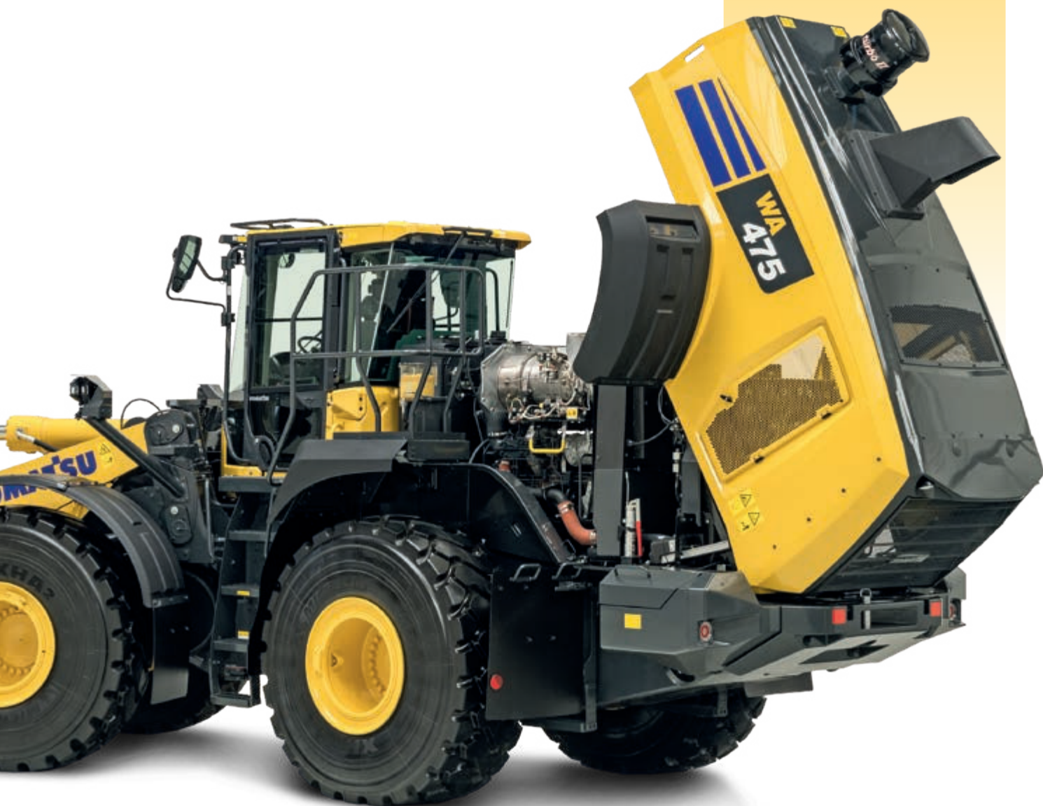
Portas de manutenção bem localizadas permitem um acesso seguro e conveniente aos pontos de serviço diários
