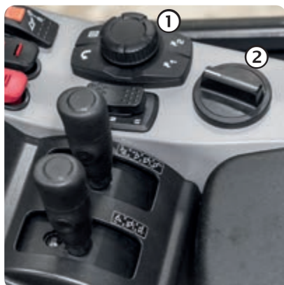
Alavanca curta de direção da Komatsu (K-SLS) – (opcional)
