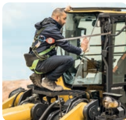
Degrau dianteiro de limpeza para um acesso fácil e seguro à janela dianteira
