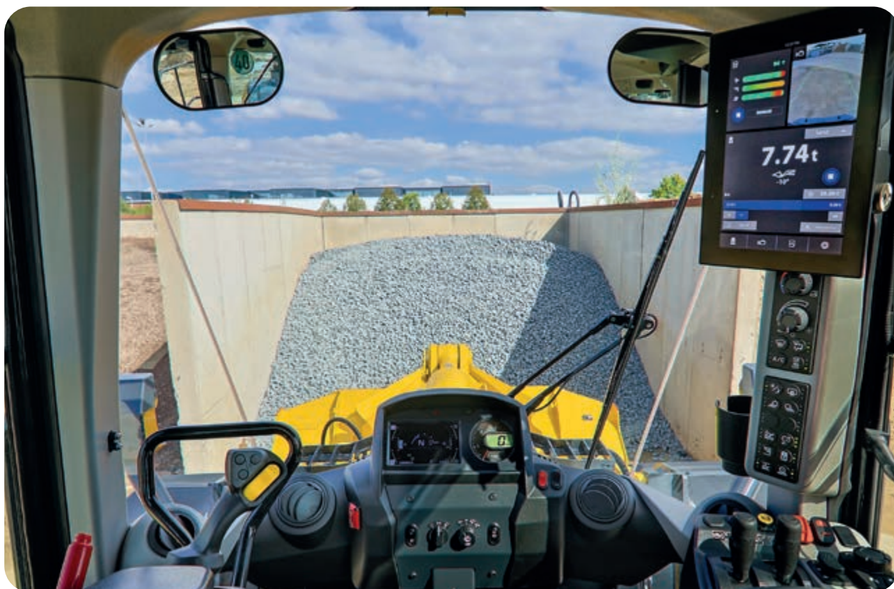
A imagem mostra o Sistema de direção avançado com alavanca de comando (Advanced Joystick Steering System = AJSS) e o SubMonitor (equipamentos opcionais)
