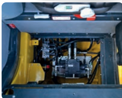
Graças ao capô interno da cabina, a manutenção extra da válvula principal pode ser feita sem ser necessário bascular a cabina
