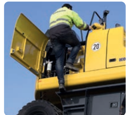
Corrimões e placas antideslizantes
