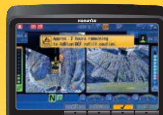
Nível de AdBlue® e orientação de reabastecimento
