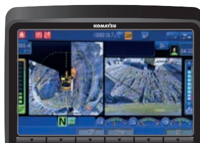
Com o sistema KomVision, as várias câmaras disponíveis ajudam a manter a visualização "birdview"
