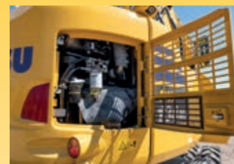
Os principais pontos de manutenção podem ser facilmente acedidos ao nível do solo
