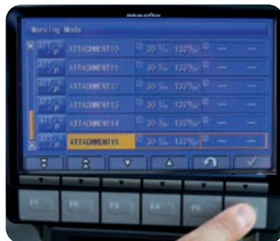
Controlo de acessório integrado Komatsu (KIAC) com até 15 predefinições de acessórios para caudal de óleo e pressão (opcional)
