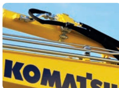
Válvulas de ruptura da mangueira no cilindros da lança e do braço
