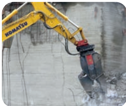
Estão disponíveis duas linhas hidráulicas opcionais para montar diversos acessórios
