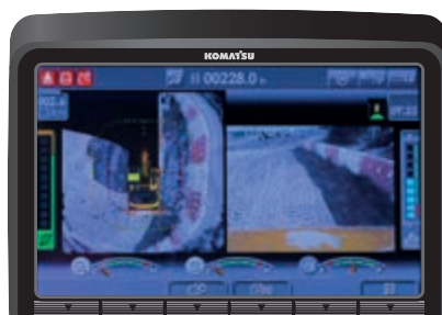
Com o sistema KomVision, é possível observar as várias câmaras disponíveis ou manter a visualização "birdview"
