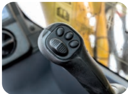
Controlo cómodo, ergonómico e preciso: alavancas de comando com botão de controlo proporcional para os acessórios
