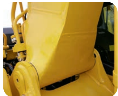
Base da lança em aço fundido e placas de lança de uma peça inteira
