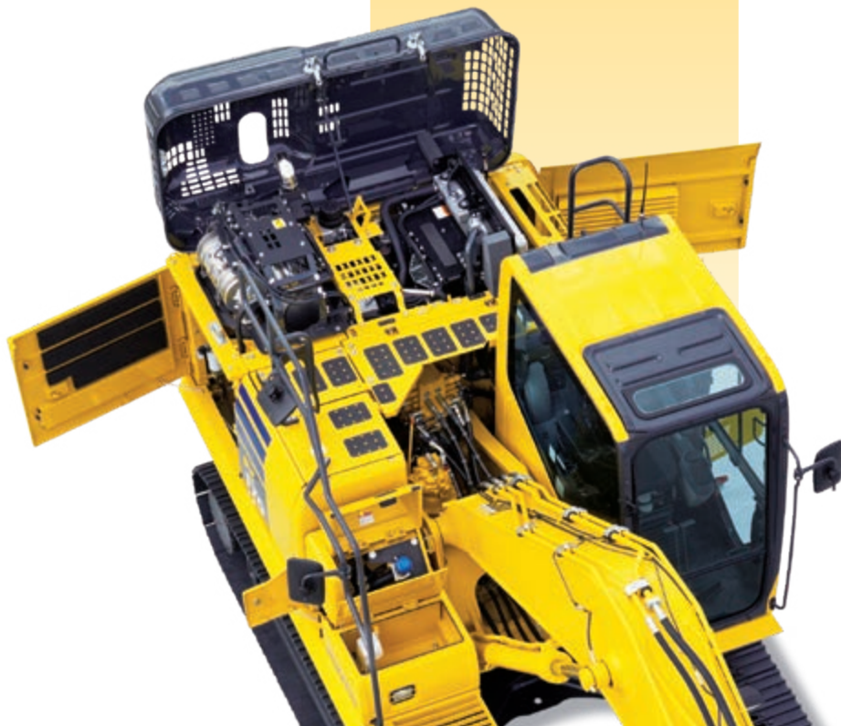
Para um acesso simples, o depósito AdBlue® está instalado junto dos degraus dianteiros
