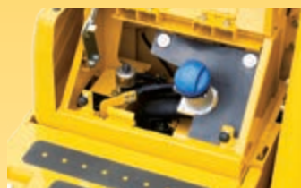
Para um acesso simples, o depósito AdBlue® está instalado junto dos degraus dianteiros
