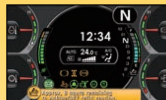
Nível de AdBlue® e orientação de reabastecimento
