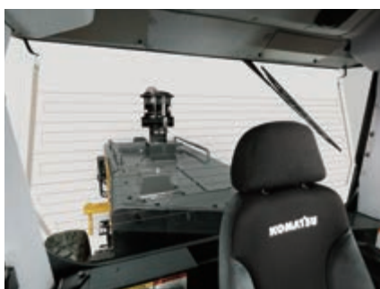
O capot do motor baixo e estreito permite uma visão desobstruída para trás
