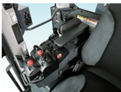
A altura da consola de braço pode ser eletricamente ajustada
